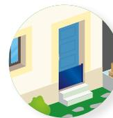
Limiter les entrées d'eau dans le bâti par la pose de batardeaux ou l'occultation temporaire des aérations basses.
