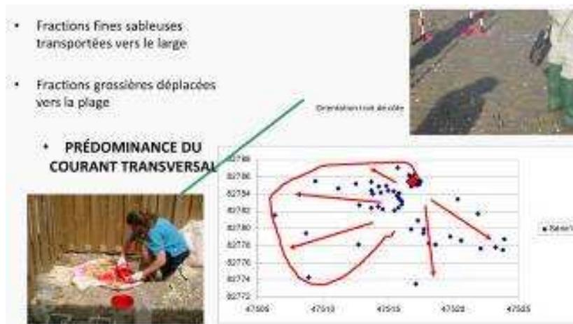
Figure 76 : expérience sur le mouvement des sédiments par l'analyse du déplacement de coquilles colorées.
